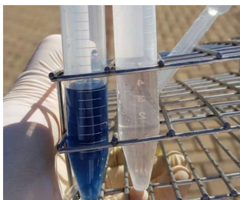
Figura 24 - Degradação do corante antes e depois do processo de fotocatalise, empregando-se o catalisados \text{CoO}_x
