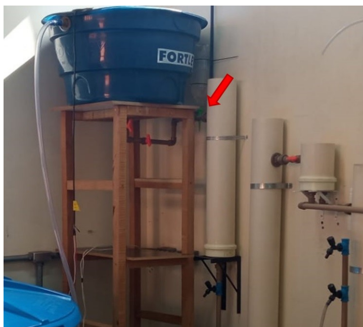
FIGURA 8 – Ponto de aplicação do coagulante na segunda e terceira carreira de filtração.
