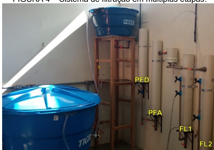
FIGURA 4 – Sistema de filtração em múltiplas etapas.
