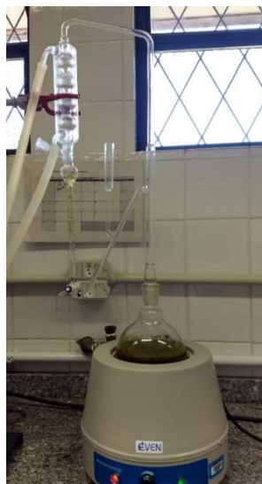
Figura 8: Apparatus utilizados na extração dos óleos essenciais. Fonte: Autoria própria.
