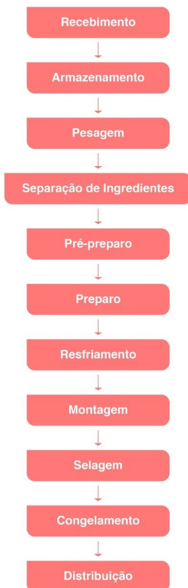
Figura 01 – Fluxograma do processo de produção de pratos prontos congelados
