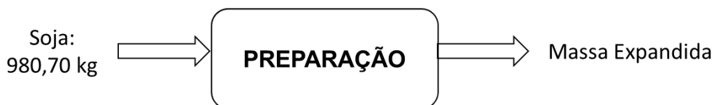
Figura 16 – Fluxos de entrada e saída na Preparação na condição de ausência de um sistema de separação de cascas.
