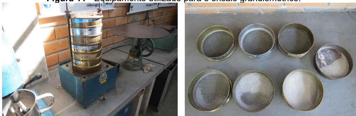
Figura 11 - Equipamento utilizado para o ensaio granulométrico.
