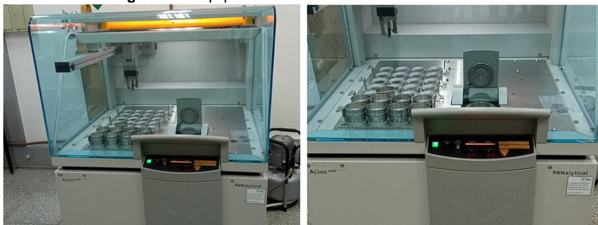
Figura 12 - Equipamento utilizado no ensaio de FRX.
