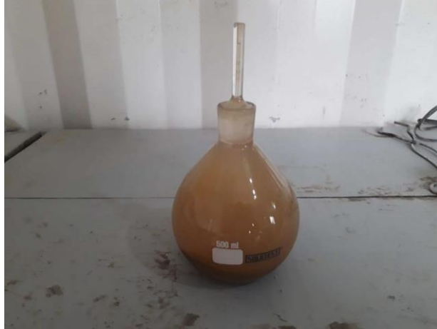
Figura 10 - Picnômetro para determinação da massa específica.
