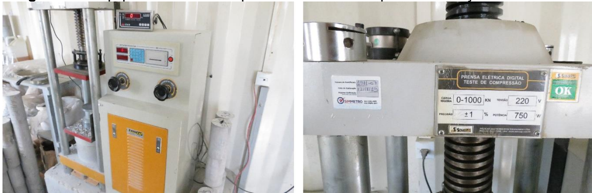
Figura 16 - Equipamento utilizado para os ensaios: compressão e tração na flexão.
