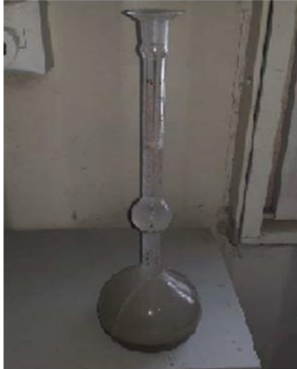
Figura 9 - Frasco de Le Chatelier para ensaio da massa específica do aglomerante.
