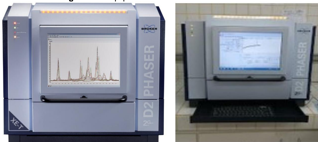
Figura 13 - Equipamento utilizado no ensaio de DRX.
