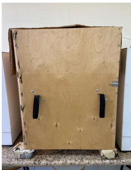
(a) Caixote de MDP fechado para isolamento da iluminação interna e externa
