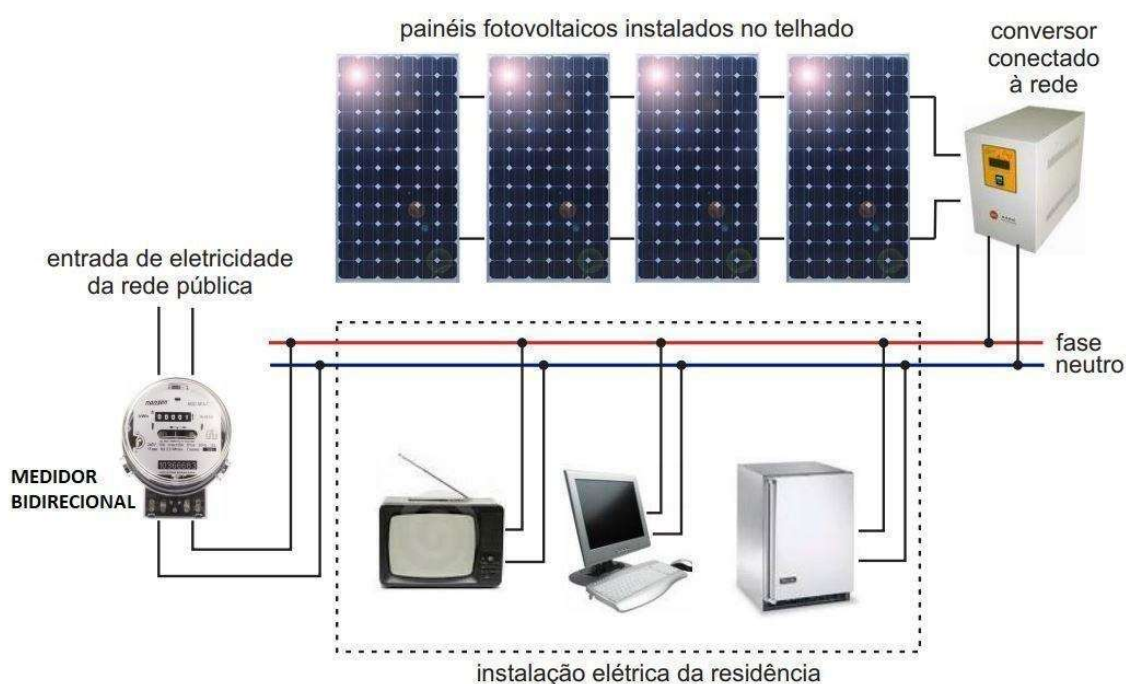
Figura 5: Ilustração de Sistema Fotovoltaico conectado à rede
