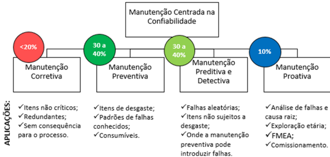
Figura 2 – Tipos de manutenção e suas proporções conforme padrões de manutenção centrada na confiabilidade
