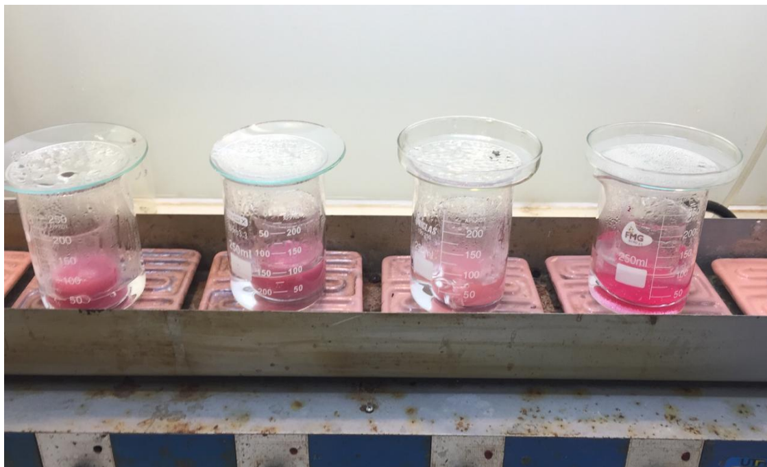
Figura 4 – Amostras de batom solubilizadas no solvente em banho-maria
