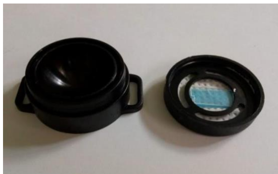
Figura 11- Câmara de difusão aberta, filtro de papel GF 52°C e detector CR-39
