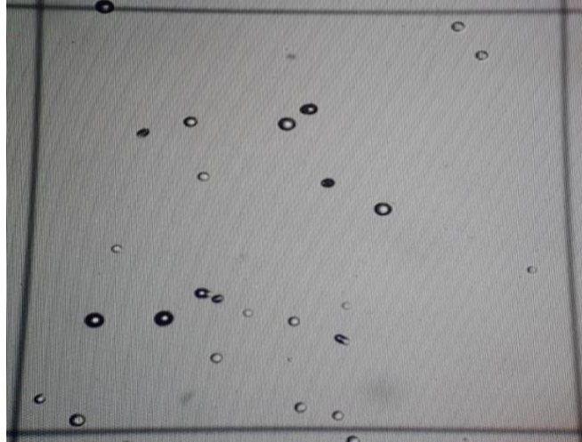
Figura 17- Visualização de 1mm 2 do detector CR-39 com a grade
