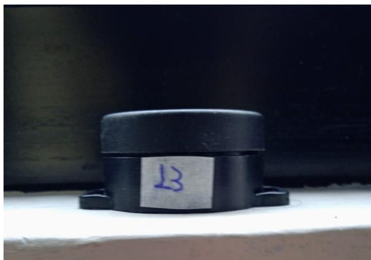
Figura 12- Câmara de difusão montada e identificada através de numeração
