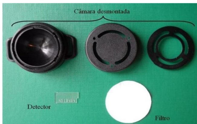
Figura 9- Elementos que fazem parte do conjunto de detecção de radônio utilizado nesta pesquisa
