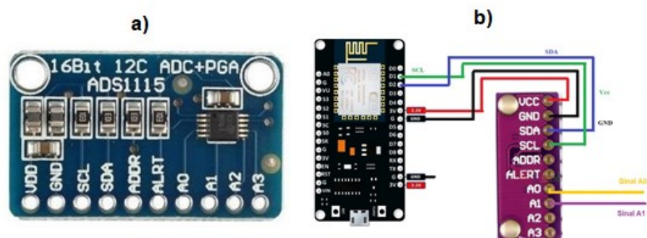
Figura 13 – a) Conversor analógico digital ADS1115. b) Diagrama de conexão ESP8266 e ADS1115.
