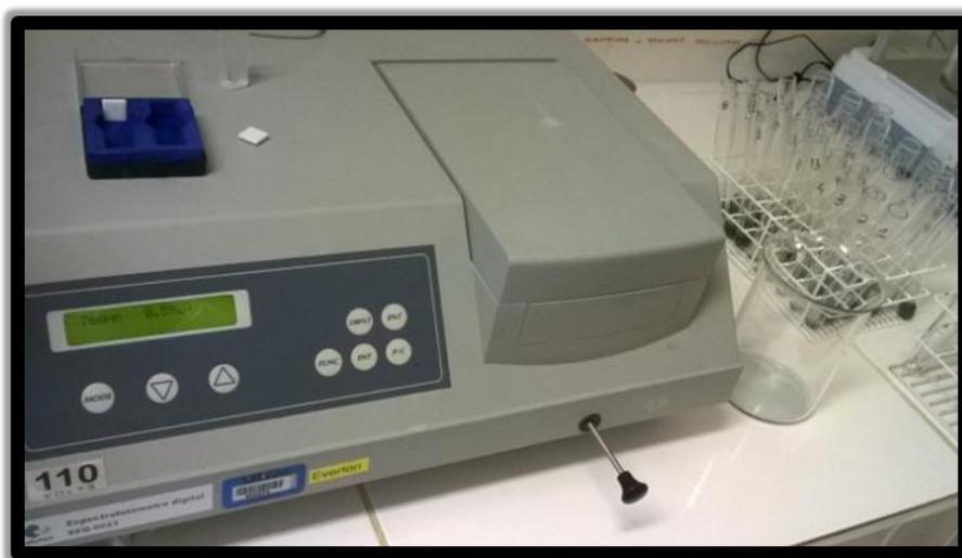
**Figura 5** - Material no espectrofotômetro para quantificar a absorbância. Fonte: Autoria própria, 2017.
