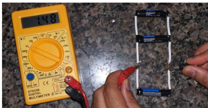
Figura 7 – Medidas da ddp de três pilhas em associação em paralelo.
