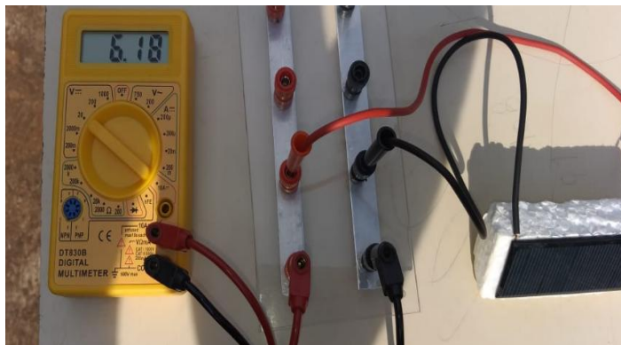
Figura 8 – Medida da ddp de uma célula solar.
