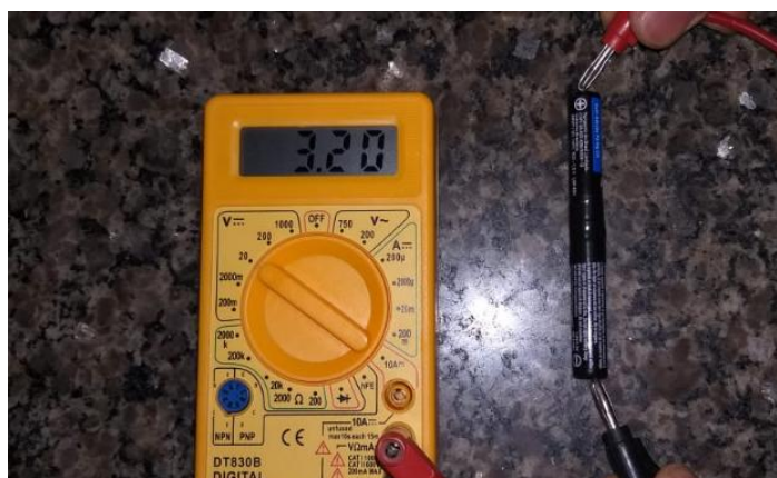
Figura 5 – Medida da ddp de duas pilhas na associação em série.
