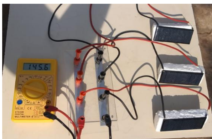
Figura 12 – Medida da corrente elétrica de três células solares.
