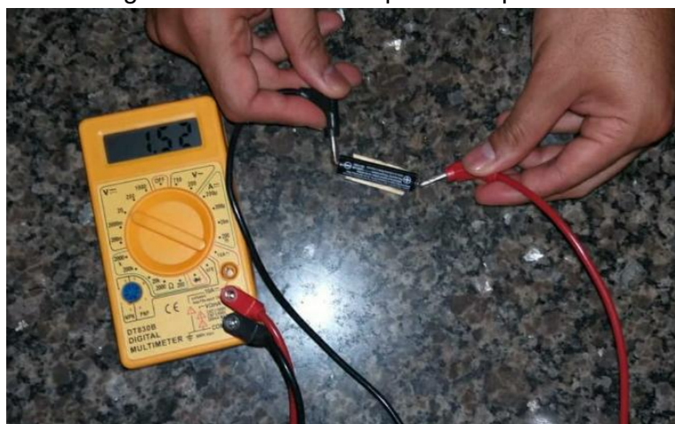
Figura 4 – Medida da ddp de uma pilha.
