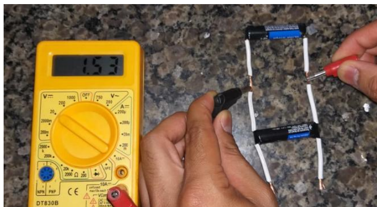
Figura 6 – Medida da ddp de pilhas associadas em paralelo.
