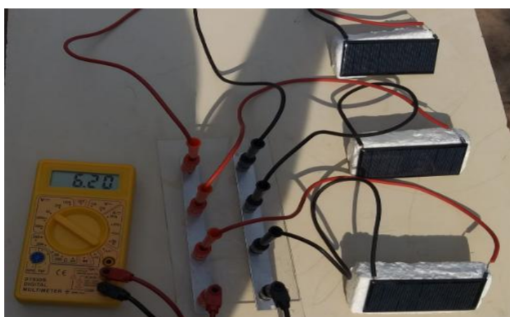
Figura 9 – Medida da ddp de três células solares.
