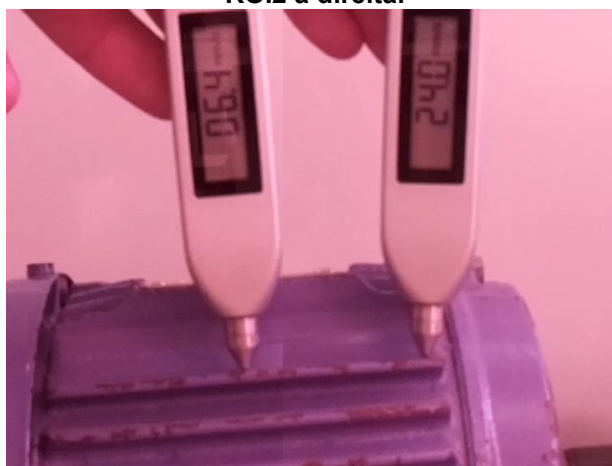
Figura 23 – Leitura dos níveis de vibração utilizando o medidor de vibração. ROI1 à esquerda e ROI2 à direita.
