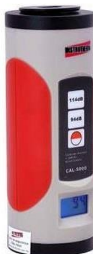
Fotografia 2 - Calibrador acústico Instrutherm® CAL-5000, equipamento empregue para auxiliar no ajuste da precisão do sonômetro antes das medições.
