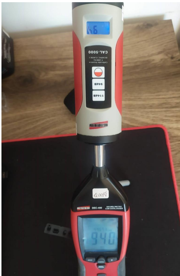
Fotografia 3 - Demonstração da calibração do Sonômetro sendo
