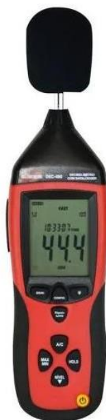
Fotografia 1 - Sonômetro Instrutherm® modelo DEC-490, instrumento utilizado nas medições do Nível de Pressão Sonora.
