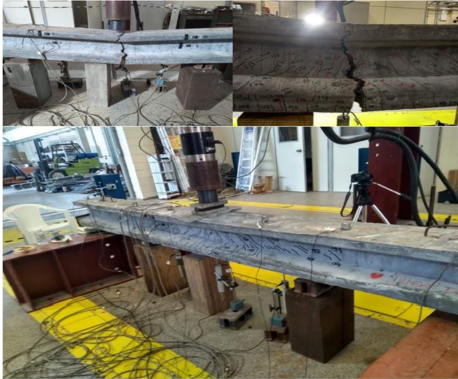
Figura 3 – Modo de falha em viga de UHPFRC protendida
