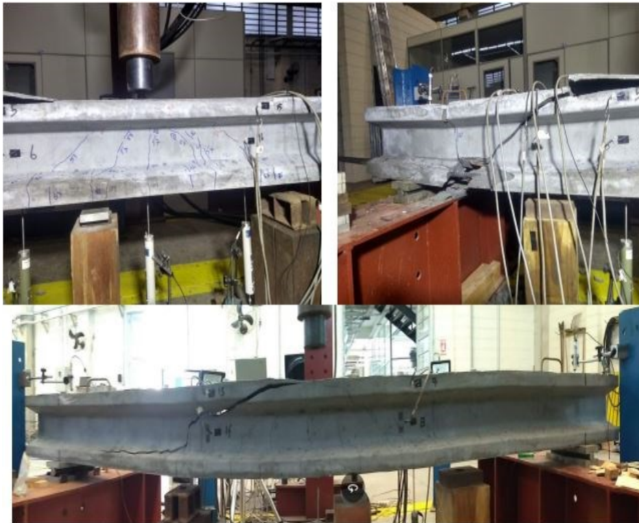
Figura 2 – Modo de falha em viga de UHPC protendida
