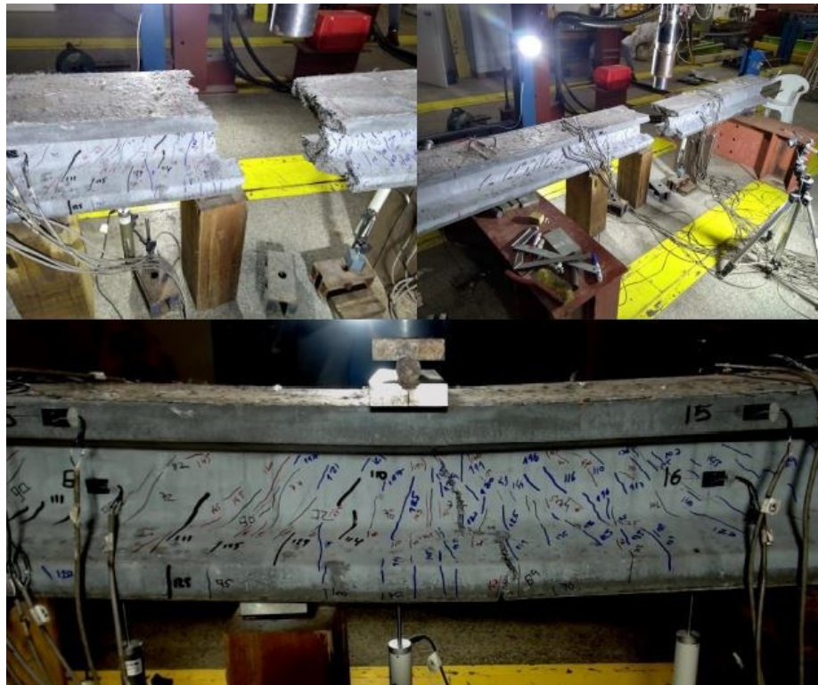
Figura 4 – Modo de falha em viga de UHPFRC sem protensão
