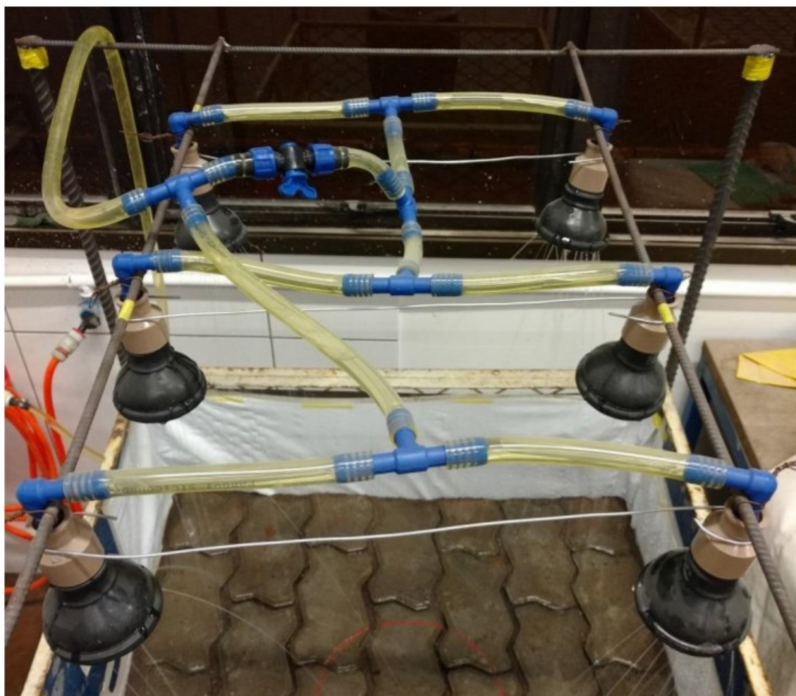
Figura 23 – Simulador de chuvas de Mallmann (2017).
