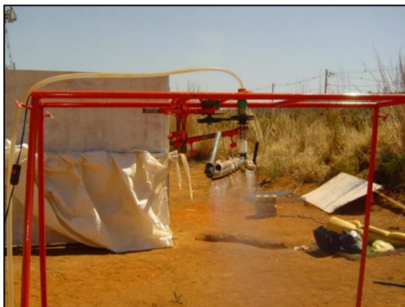
Figura 10 – Detalhe do funcionamento do simulador de chuva de Moura (2005).
