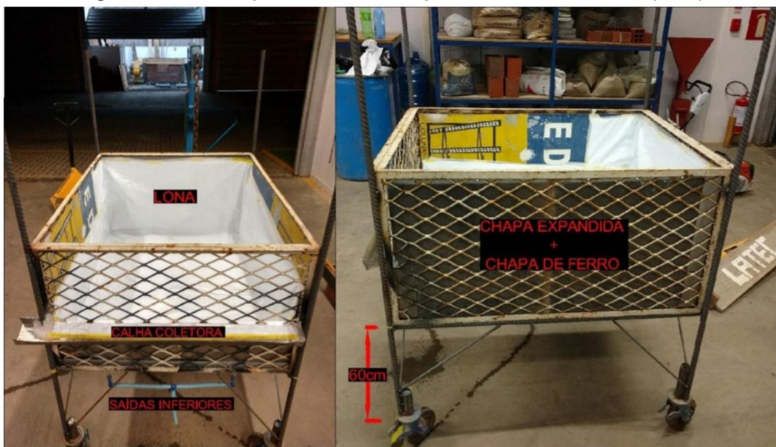
Figura 22 – Modelo para execução dos pavimentos de Mallmann (2017).
