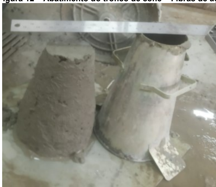
Figura 12 – Abatimento do tronco de cone – Fibras de aço
