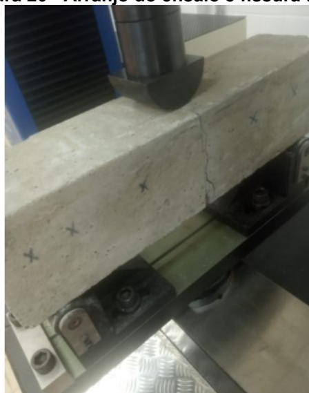
Figura 20 - Arranjo do ensaio e fissura típica
