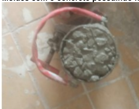
Figura 14 - Moldes com o concreto possuindo fibras de aço
