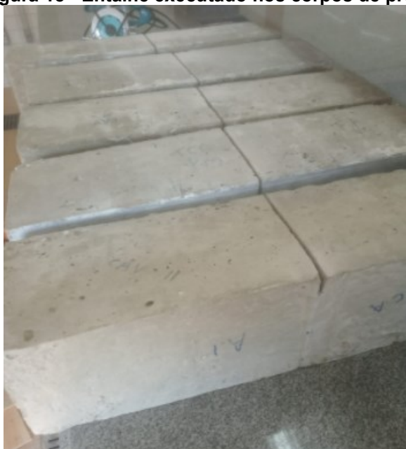
Figura 18 - Entalhe executado nos corpos de prova
