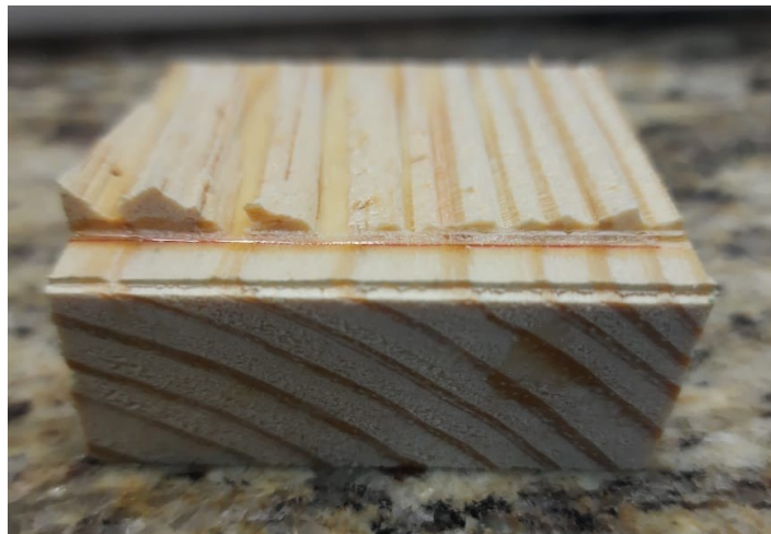
Figura 9 - Corpo de prova rompido após o ensaio de cisalhamento na linha da cola
