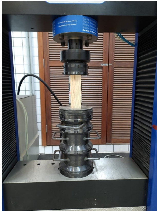
Figura 5 - Ensaio de resistência à compressão paralela às fibras
