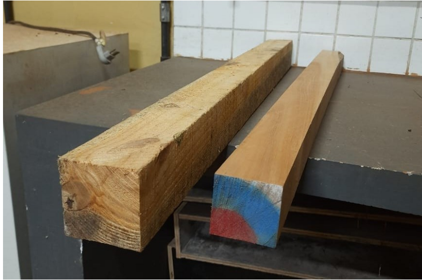
Figura 3 – Exemplos das madeiras de Pinus sp. (esquerda) e Eucalyptus urograndis (direita)
