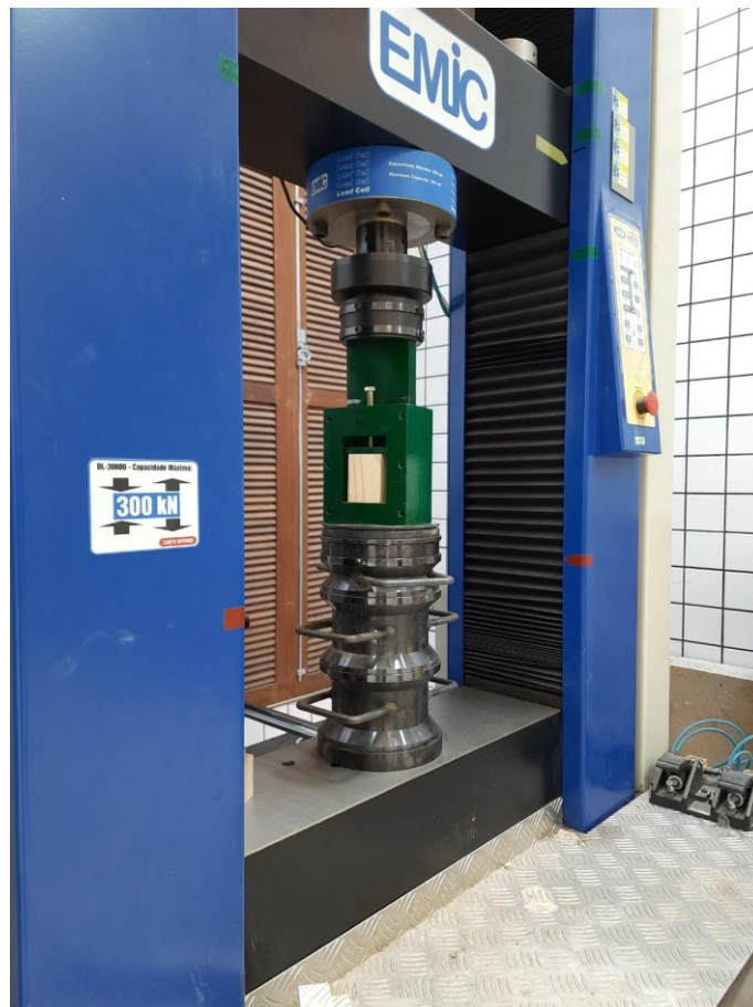
Figura 6 - Ensaio de resistência ao cisalhamento paralelo às fibras
