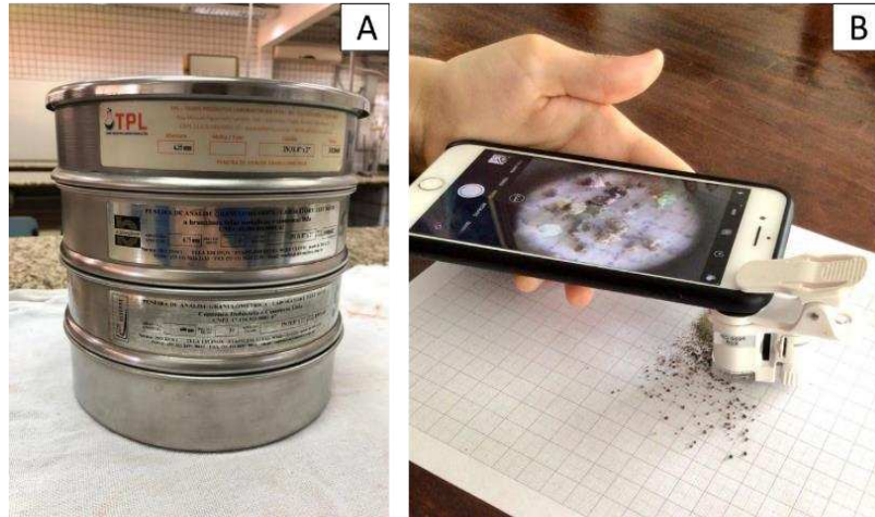
Figura 14 – Materiais utilizados para o processo de peneiramento das amostras. (A) Peneiras utilizadas. (B) Exemplo da análise fotográfica realizada com o microscópio de 60 vezes para celular
