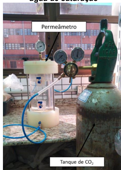
Figura 7 – Permeâmetro e tanque de CO 2 utilizado para incorporação do dióxido de carbono na água de saturação
