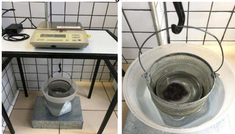
Figura 15 – Balança hidrostática utilizada para aferição da massa do agregado submerso na água
