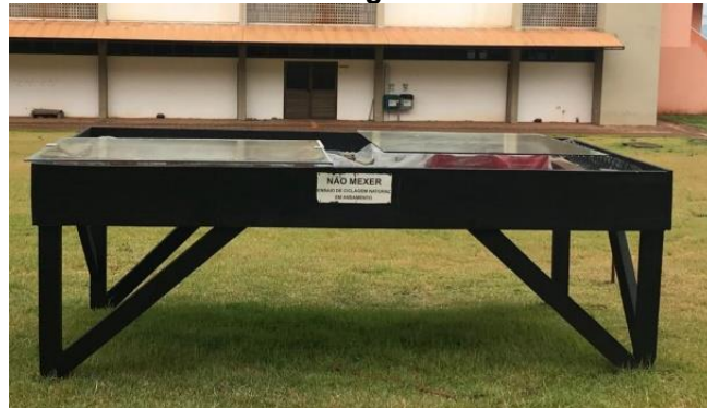
Figura 10 – Bancada experimental ao sol, onde as amostras passam pelo processo de secagem
