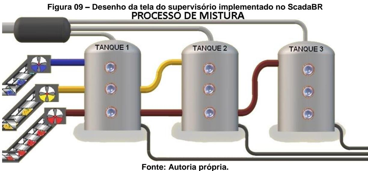
Na Figura 09, o processo de mistura é operado pelas ações das bombas dos tanques e dos motores alimentadores e misturadores, além do alimentador geral, de modo a se ter o controle de acionamento e a velocidade de rotação de cada atuador.
