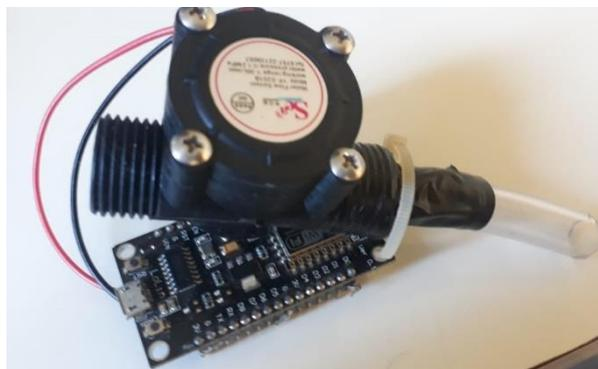
**Figura 9** Microcontrolador conectado ao sensor.
