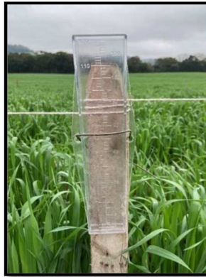
Figura 6 - Pluviômetro instalado no local do experimento
