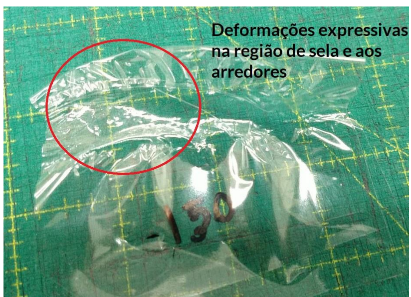
Figura 31 – Aspecto observado em casos de deformações expressivas na região de sela e em suas adjacências
