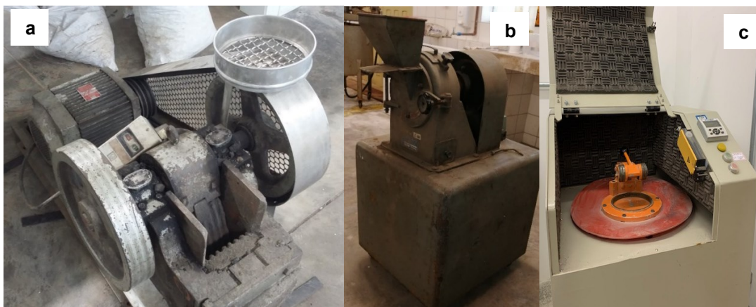
Figura 8 - Moagem do resíduo de carvão: a) moinho de mandíbula b) moinho de discos c) moinho de panela
