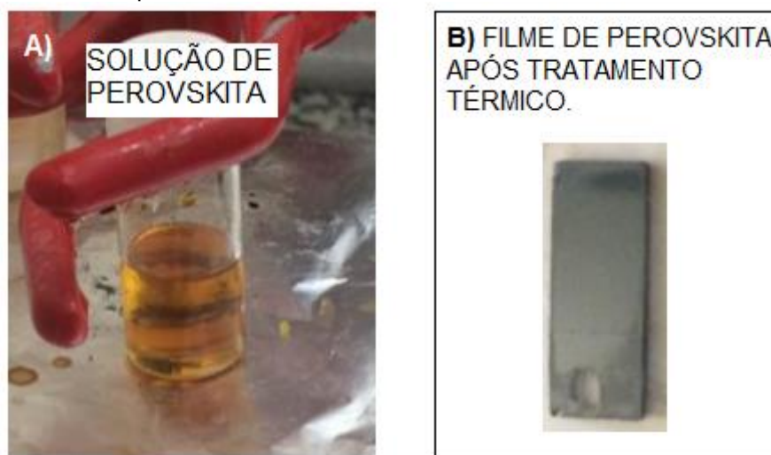
Figura 16 – (A) Solução precursora de perovskita; (B) Filme de perovskita após o tratamento térmico.
