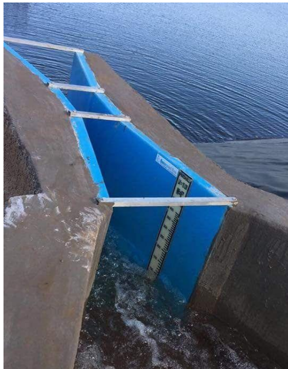
Figura 8 - Escoamento de fluido através de uma Calha Parshall
