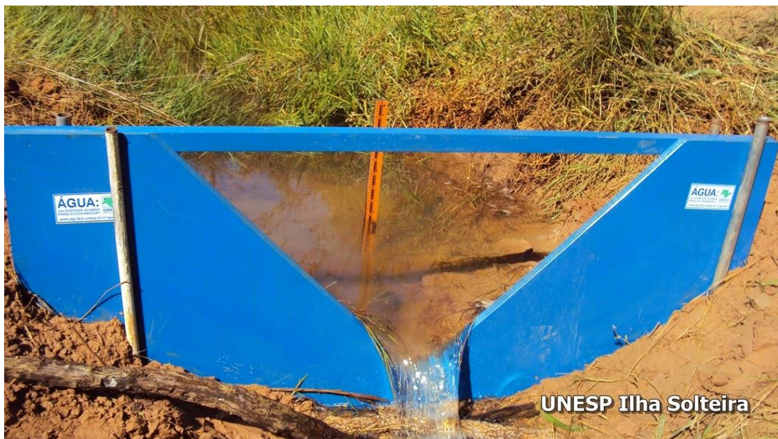
Figura 6 - Fluido escoando através de um Vertedor triangular
