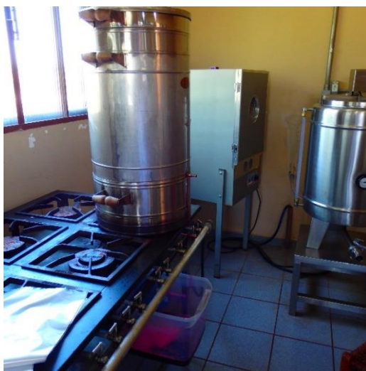
Figura 8 Extrator de suco de jabuticaba por vapor. Capacidade máxima para 40 \text{ kg h}^{-1} , e temperatura de extração de 80 \text{ }^{\circ}\text{C} .
