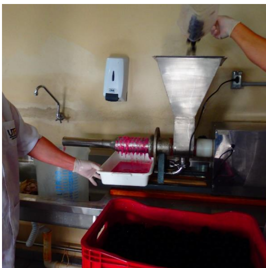
Figura 7 Despoldadora de frutas com estrutura em aço inoxidável com Bocais em alumínio polido, com capacidade para até 100 \text{ kg h}^{-1} .
