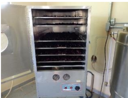
Figura 11 Desidratador de (7) bandejas com sistema de circulação de ar forçado, aquecido por gás GLP e controle automático de temperatura (modelo PEG 30, CLASSIC).
