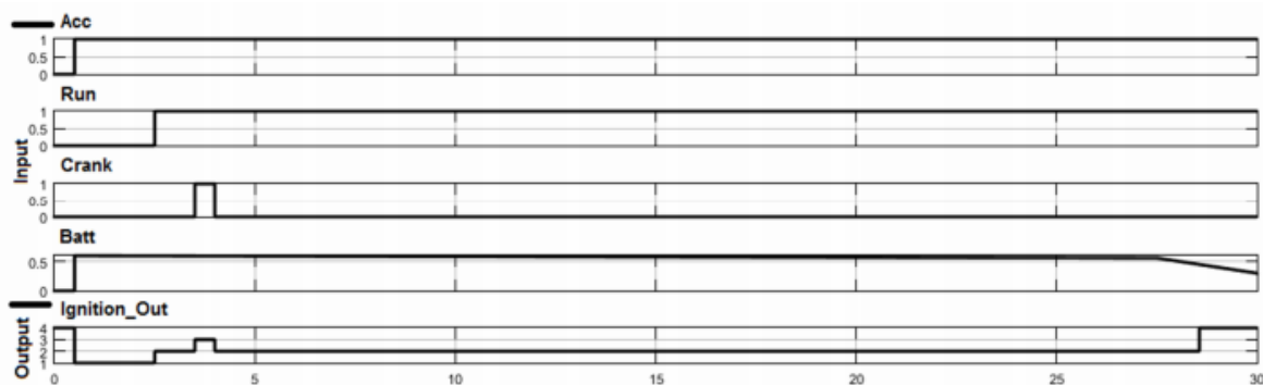
Figura 30 - Sinais simulados do sistema de habilitação do painel de instrumentos
