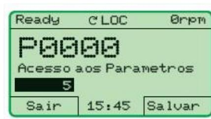
Passo 3 - No modo de “Monitoração”, pressione “Menu” utilizando a “soft key” direita.
