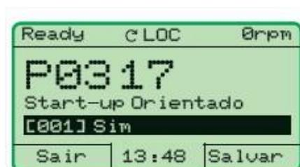
Passo 6 - Neste momento é iniciada a rotina do “Start-up orientado”. Com as teclas de navegação, altere os valores dos parâmetros de acordo com seu motor e aplicação.
