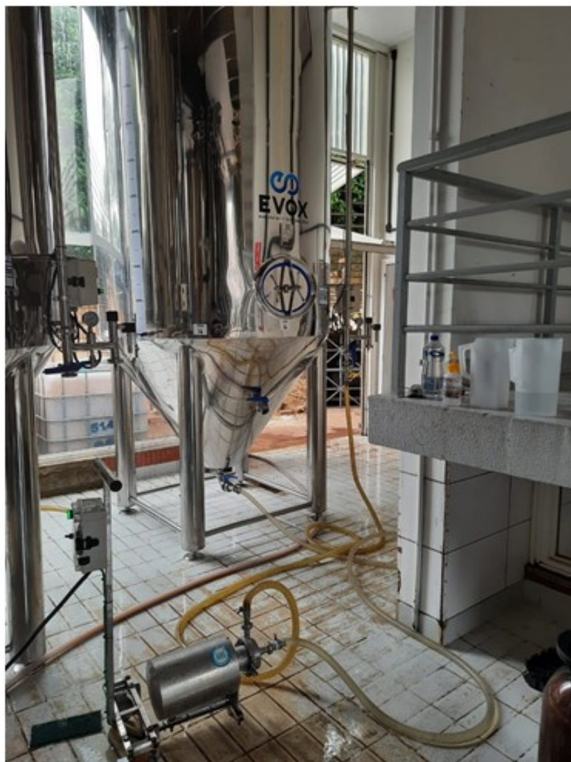
Figura 13: Clean in place de um Tanque Fermentador
