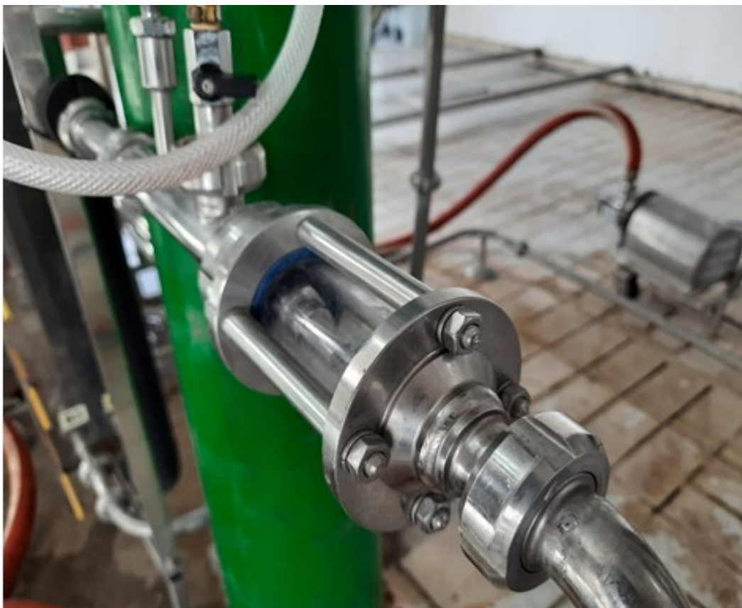
Figura 10: Sistema de Oxigenação do Mosto com Visor
