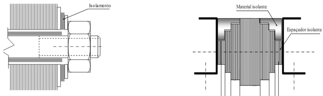
Figura 2: Detalhes núcleo da parte ativa e suas isolações. Fonte: Transformadores (RIES, Walter, 2002)
