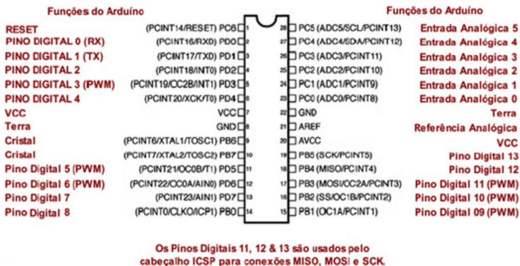
Figura 4 - Mapeamento da pinagem do ATMEGA 328.
