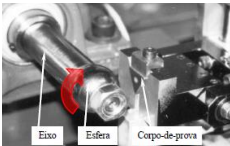
Figura 11 - Equipamento de ensaio de desgaste micro abrasivo por esfera rotativa fixa.
