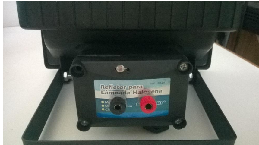
Figura 14– Imagem traseira da luminária autônoma com o sensor LDR e os bornes de entrada.
