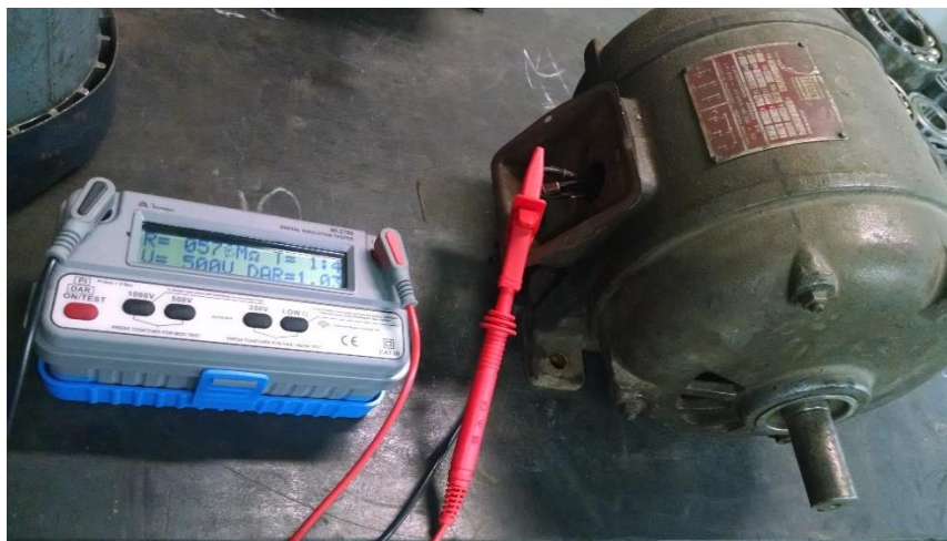
Figura 13 - Medição em motores do laboratório de manutenção
