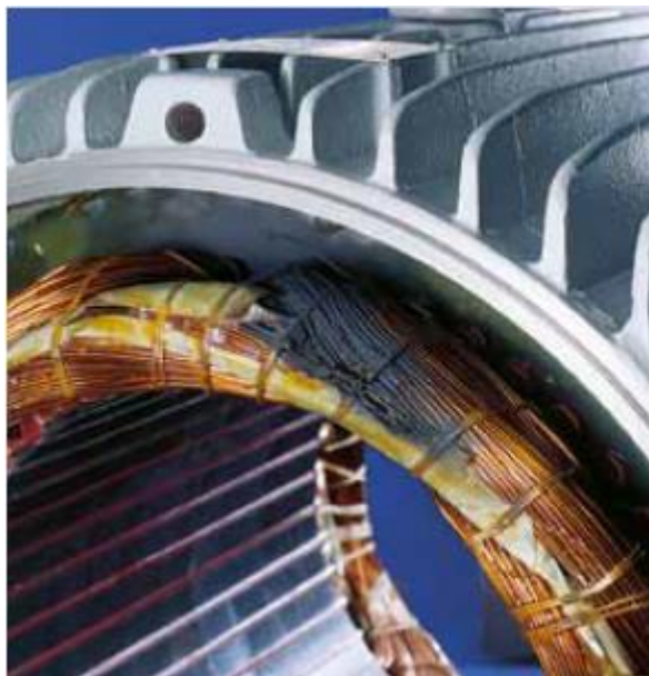
Figura 5 - Curto-circuito entre fases Fonte - WEB, 2012.
