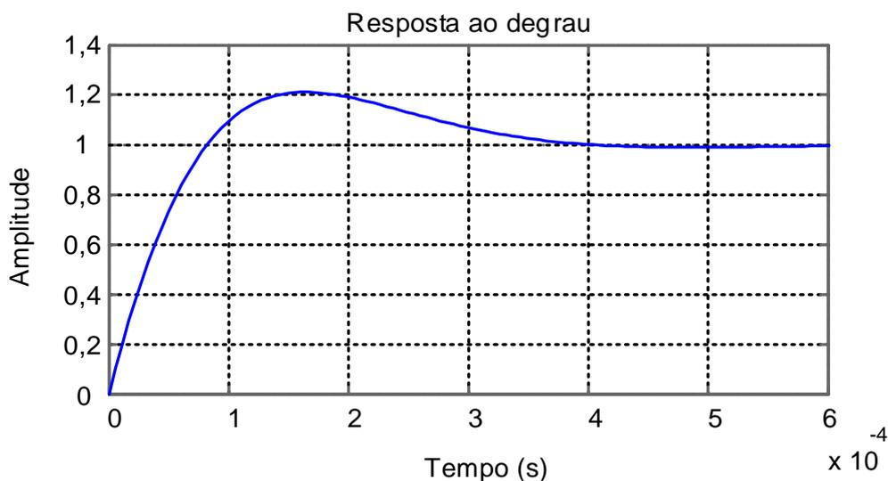
Figura 5.5 - Resposta ao degrau da função transferência da malha de corrente com o compensador PI.
