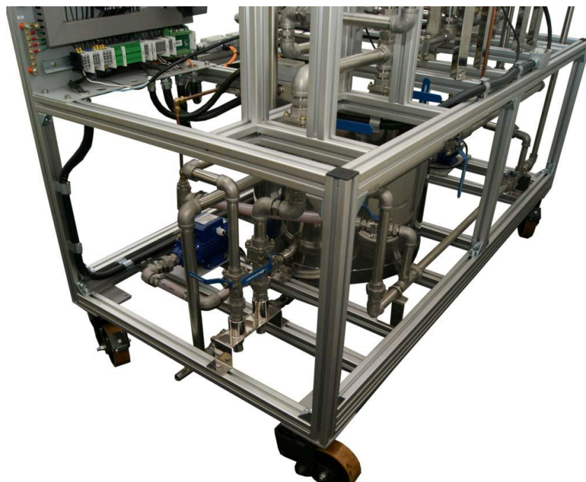
Figura 11: Saída de escoamento da água e entradas de abastecimento de água. Fonte: SMAR (2012, p. 20).
