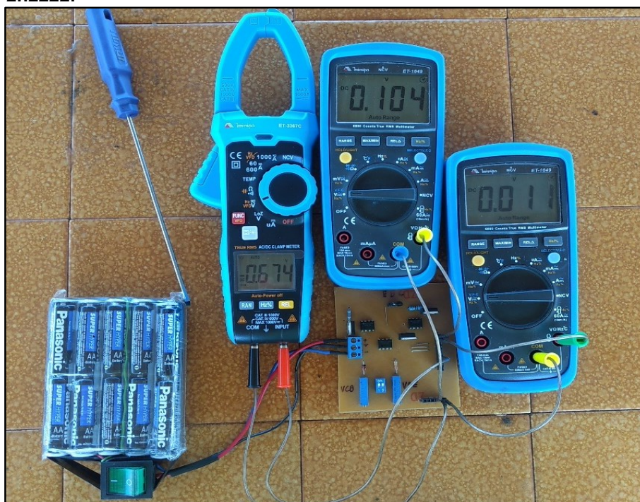
Figura 21 – Experimento medição das correntes I_C e I_B para o transistor 2n2222.
