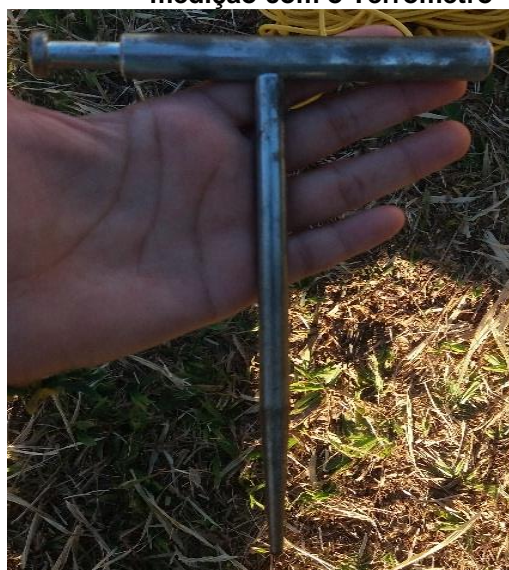
Figura 15 – Eletrodo auxiliar para medição com o Terrômetro
