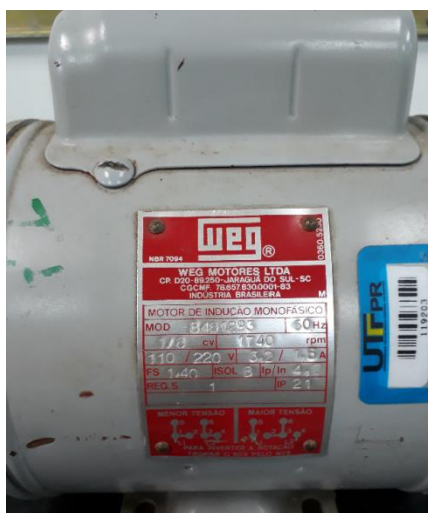
Figura 15 - Dados da plaqueta do motor em análise.
