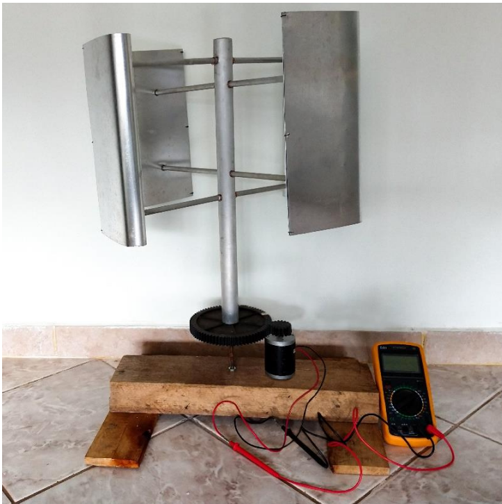
Figura 14 – Protótipo do sistema de geração.
