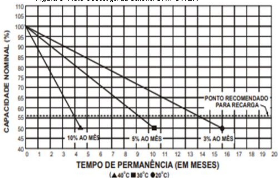
Figura 6- Auto-descarga da bateria UNIPOWER
