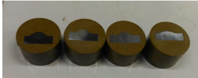
Figura 7 Corpos de Prova Embutidos em Baquelite
