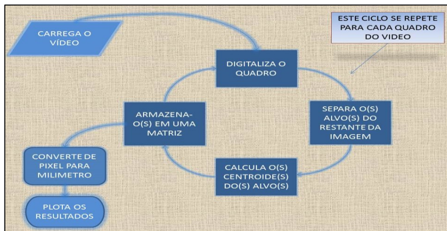
Figura 6. Fluxograma do processamento de imagens
