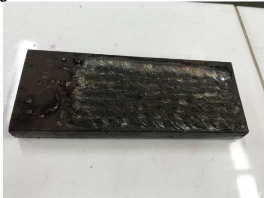
Figura 6 - Soldagem do eletrodo revestido 410 NiMo no metal base CA6NM
