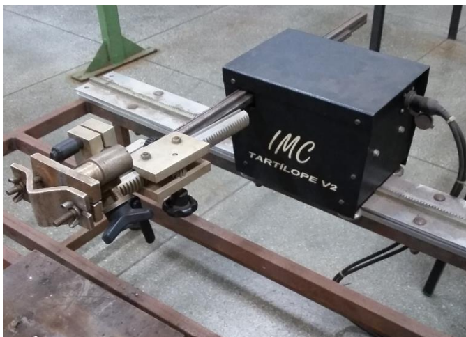
Figura 10: Carro matriz de soldagem modelo Tartílope do fabricante SPS
