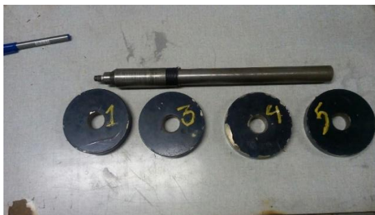
Figura 16: Haste com ponta de diâmetro e os pesos utilizados no ensaio
