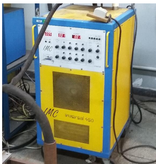
Figura 7: Central de Soldagem Inversal 450 do fabricante IMC Soldagem
