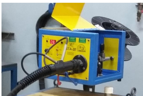
Figura 8: Sistema de alimentação modelo STA-20, do fabricante IMC Soldagem
