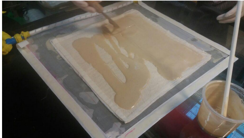
Figura 12: Última camada de PU, cobrindo as sete fibras de algodão.
