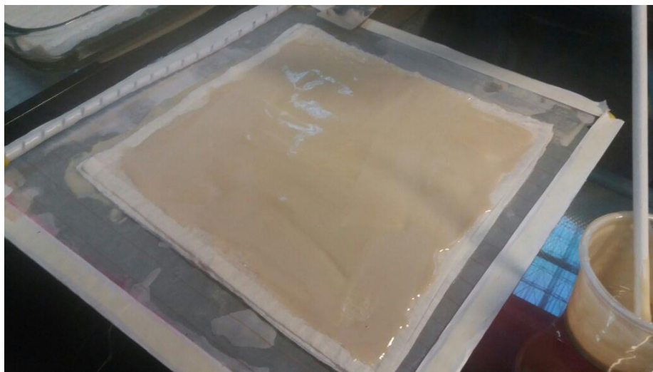
Figura 11: Camada intermediária de PU cobrindo as quatro camadas de algodão.
