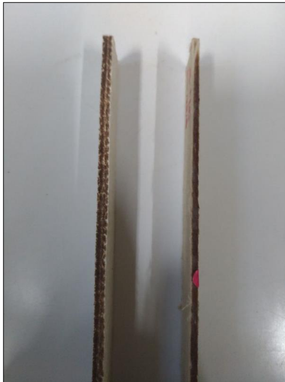
Figura 18: Lado esquerdo o compósito hidratado e Lado direito o não hidratado.
