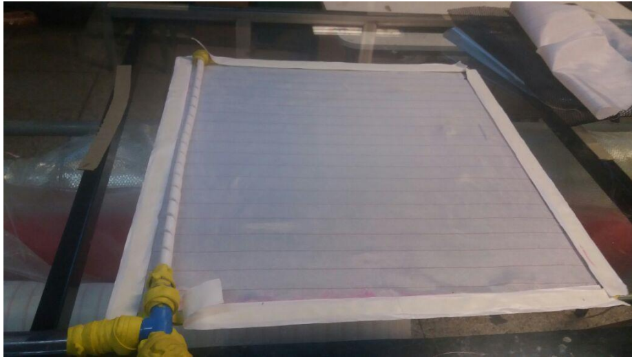
Figura 8: Limitação da bolsa, PEEL PLY e conexão em T já instalado.
