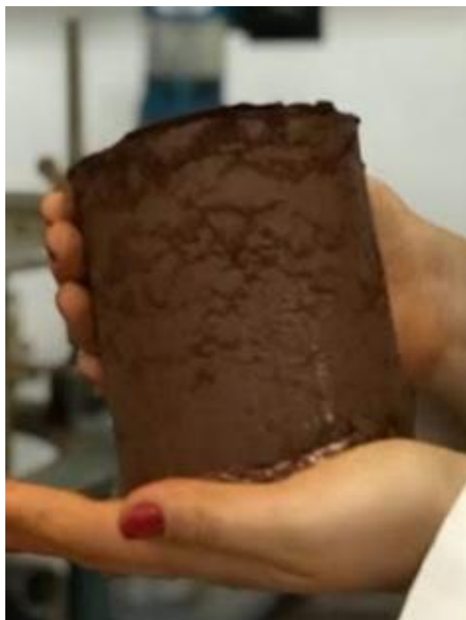
Figura 22 - Compactação em umidade ótima
