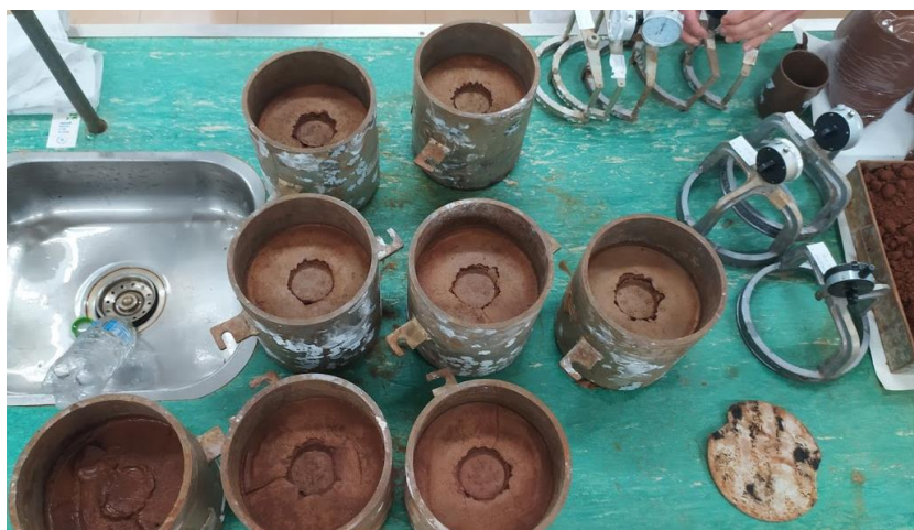
Figura 23 - Corpos de Prova após a realização do ensaio de penetração.
